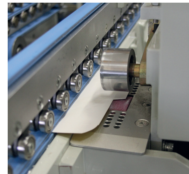
Grinder zum Aufrauen von lackierten Flächen
